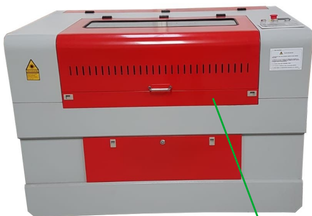
Ilustración 16: Puerta auxiliar frontal
