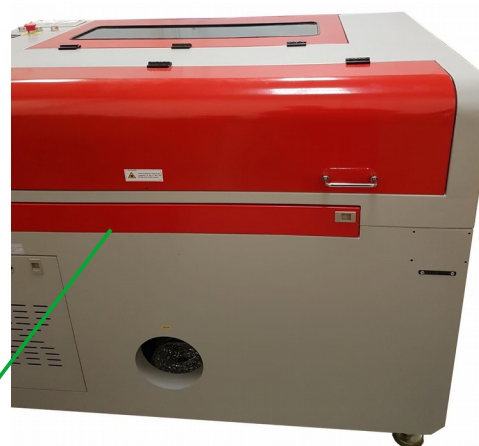
Ilustración 17: Puerta auxiliar posterior
