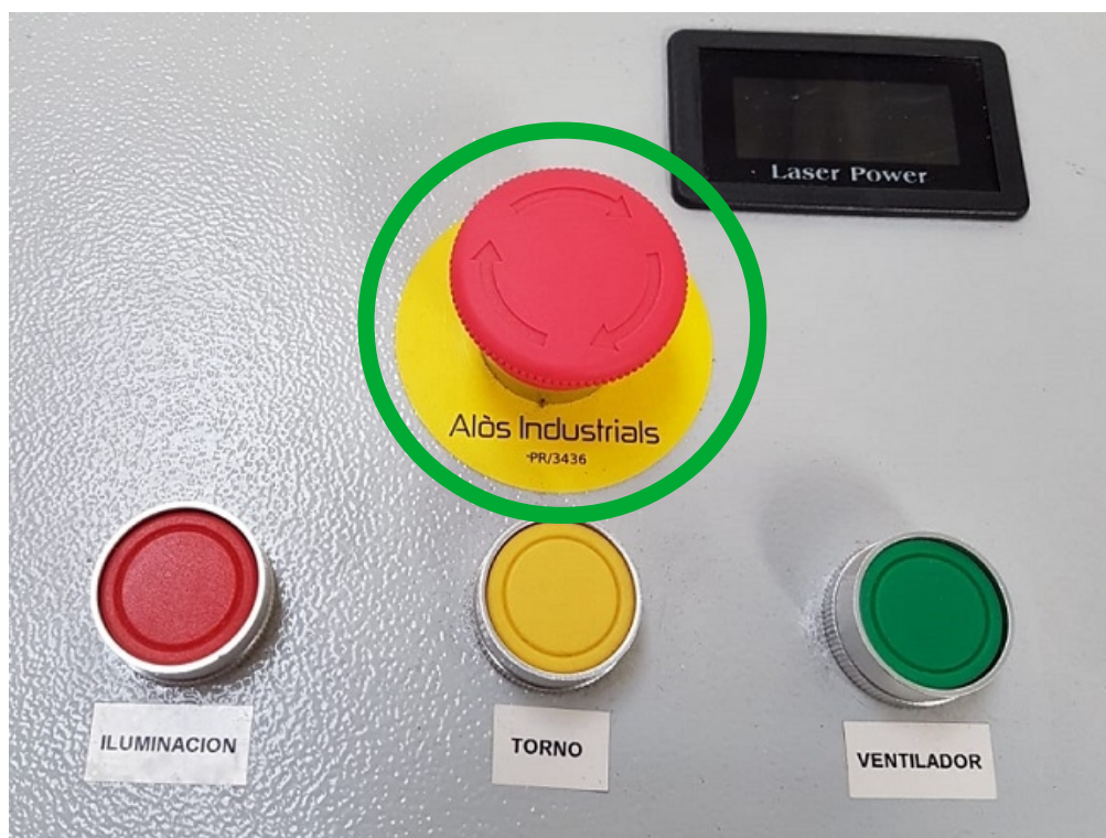
Ilustración 22: Pulsador de emergencia
